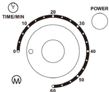
**Timer-Drehknebel (3).** Stellt die Betriebszeit des Ofens ein (max. 60 Minuten). Drehen Sie den Drehknebel im Uhrzeigersinn auf den gewünschten Zeitwert; am Ende der Zeit schaltet der Ofen ab, der Drehknebel geht allmählich in die Position "0" zurück (gleichzeitig ertönt ein akustisches Signal). Wenn Sie sich entscheiden, den Zyklus zu unterbrechen, drehen Sie den Drehknebel einfach gegen den Uhrzeigersinn in die Position "0". Wenn sich der Drehknebel in der Position "0" befindet,
