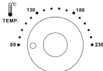
**Thermostat-Drehknebel (1).** Regelt die Innentemperatur des Backofens (max. ca. 230°C); drehen Sie den Drehknebel auf den gewünschten Temperaturwert: die Heizelemente schalten sich ein und sobald die eingestellte Temperatur erreicht ist, schalten sie sich aus; sie schalten sich wieder ein, sobald die Temperatur sinkt.
