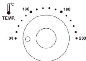
**Bouton thermostat (1).** Régule la température interne du four (max 230°C environ). Tournez le bouton sur la valeur de température souhaitée : les résistances s'allument et lorsque la température réglée est atteinte, elles s'éteignent ; elles se réactivent quand la température s'abaisse.
