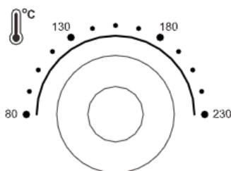
**Mando termostato (1).** Regula la temperatura interior del horno (máx 230°C aprox.); gire el mando según el valor de temperatura deseado: las resistencias se encienden y al alcanzar la temperatura configurada, se apagan; se reactivan cuando la misma disminuye.
