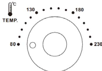
**Manopola termostato** (1). Regola la temperatura interna del forno (max 230°C circa); ruotare la manopola in corrispondenza al valore di temperatura desiderato: le resistenze si accendono e raggiunta la temperatura impostata, si spengono; si riattivano non appena questa diminuisce.
