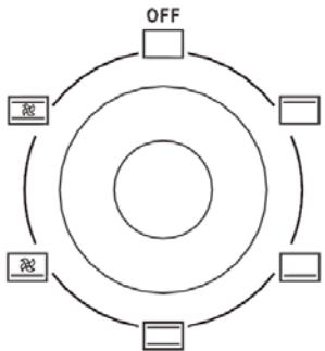
**Mando selector (2).** Selecciona las modalidades de cocción del horno y acciona las resistencias superior y/o inferior o ambas.
