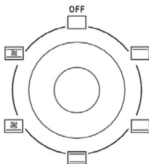
**Manopola selettore** (2). Seleziona le modalità di cottura del forno e aziona le resistenze superiore e/o inferiore o entrambe.
