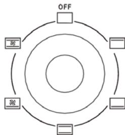
**Bouton sélecteur (2).** Sélectionne les modes de cuisson du four et active les résistances supérieure et/ou inférieure.
